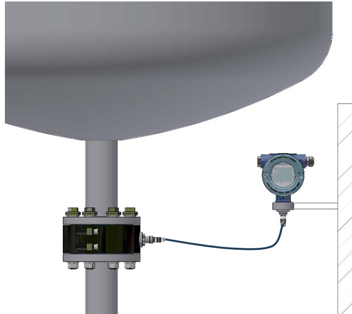
Abb. 25 ExD-Gehäuse abgesetzt mit HF-Kabel
