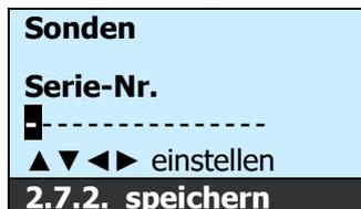
1. Mit ▲▼◀▶-Tasten wird die alphanumerische Seriennummer der Sonde eingegeben
