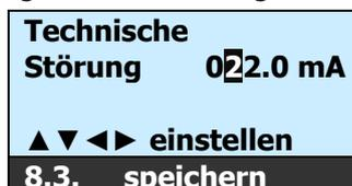
1. Mit ▲▼◀▶-Tasten wird Stromausgang definiert
