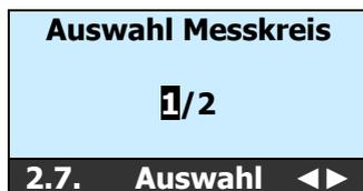
Nach Drücken der **ok**-Taste wechselt die Anzeige in das Menu des angewählten Messkreises (1). 2.7.1.
