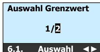
1. Mit ◀▶-Tasten wird das Ausgangsrelais oder Transistor Opencollectorausgang (NPN) 1 oder 2 definiert
