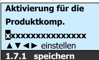
1. Mit ▲▼◀▶-Tasten wird der alphanumerische Code eingegeben
