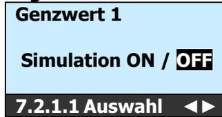
1. Mit ◀▶-Tasten wird das Ausgangsrelais oder Transistor Opencollectorausgang (NPN) 1/2 de- oder -aktiviert Digitaler Ausgang wird sofort aktiv.
