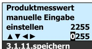
1. Mit ▲▼◀▶-Tasten wird die Messspanne definiert
