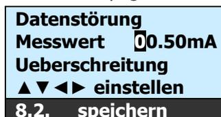
1. Mit ▲▼◀▶-Tasten wird der Stromausgang definiert
