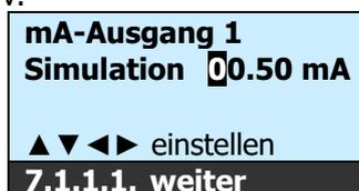
1. Mit ▲▼◀▶-Tasten wird der Stromausgang definiert Stromausgang wird sofort aktiv
