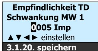
1. Mit ▲▼◀▶-Tasten wird die Signalfilterzeit definiert
