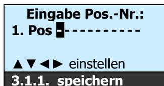
1. Mit ▲▼◀▶-Tasten wird die alphanumerische Positionsnummer eingegeben
