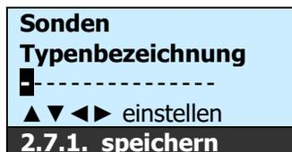
1. Mit ▲▼◀▶-Tasten wird die alphanumerische Typenbezeichnung der Sonde eingegeben
