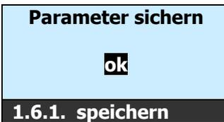
1. **ok**-Taste länger 2 Sekunden drücken; die Parameter werden im Flash-Speicher gesichert. Alte Parameter werden überschrieben
