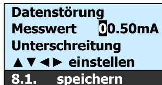
1. Mit ▲▼◀▶-Tasten wird der Stromausgang definiert
