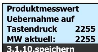
1. **ok**-Taste länger 2 Sekunden drücken; der Messwert wird übernommen und unter dem eingegebenen Produktnamen gespeichert.
