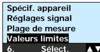
Après avoir appuyé sur la touche **ok** l'affichage passe au sous menu plage de mesure 6.1. sélectionner le circuit de mesure.
